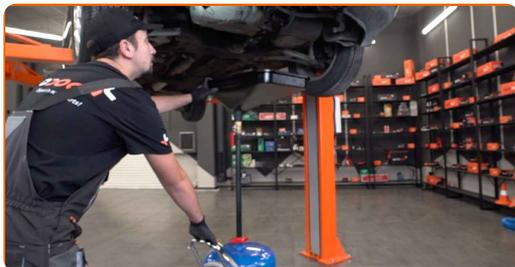
**7** Dévissez le bouchon de vidange. Utilisez une douille d'entraînement n°19 ou une clé polygonale n°19.
