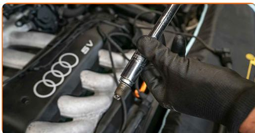
**8** Appliquez une fine couche d'antigrappant à haute température sur les fils des nouvelles bougies d'allumage.
