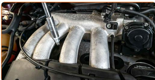
**10** Vissez les nouvelles bougies et serrez-les. Utilisez une clé dynamométrique. Servez-vous de la douille de bougie d'allumage n°16. Serrez-le jusqu'à 25 Nm.
