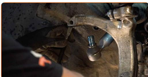
**18** Connectez l'extrémité du tirant à la fusée d'essieu.
