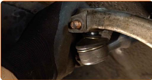
**20** Vissez l'écrou de fixation reliant l'embout de biellette à la fusée d'essieu. Utilisez une douille n° 13. Utilisez une clé à cliquet.
