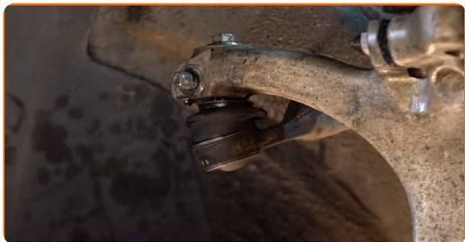
**8** Dévissez l'écrou d'attache d'extrémité à la fusée d'essieu. Utilisez une douille n° 16. Utilisez une clé à cliquet.
