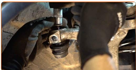
**9** Retirez l'écrou de fixation. Servez-vous d'un burin plat pour l'usinage des métaux. Servez-vous d'un marteau.
