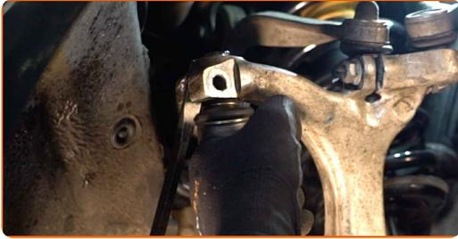
**19** Installez l'écrou de fixation.
