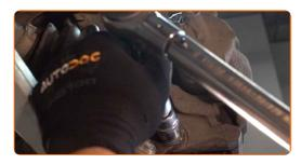
Connectez l'attache du câble du capteur ABS.
