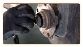
Retirez l'écrou de fixation.
