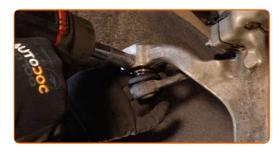
Serrez l'écrou de fixation reliant l'embout de biellette de direction à la fusée d'essieu. Utilisez une clé mixte de No.16 Utilisez une clé dynamométrique. Serrez-le jusqu'à 50 Nm.
