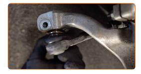
50 Installez les boulons de fixation.
