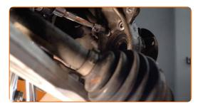
Retirez le moyeu de roue avec les roulements. Servez-vous de l'extracteur de moyeu à inertie.
