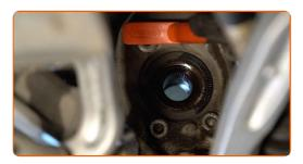
Dévissez le support du roulement de moyeu. Servez vous de la douille XZN n°12. Utilisez une clé à cliquet. Utilisez un porte-taraud.
