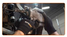
Serrez le support de l'étrier de frein. Utilisez une douille n° 21. Utilisez une clé dynamométrique. Serrez-le jusqu'à 190 Nm.
