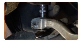
Déconnectez l'extrémité de la barre de la fusée d'essieu. Servez-vous d'un burin plat pour l'usinage des métaux. Servez-vous d'un marteau.
