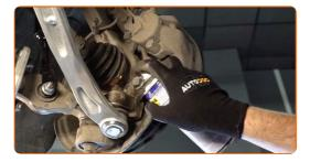
Dévissez l'attache du support d'étrier. Utilisez une douille n° 21. Utilisez une clé à cliquet. Utilisez un porte-taraud.
