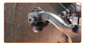
Vissez l'écrou de fixation reliant l'embout de biellette à la fusée d'essieu. Utilisez une douille n° 13. Utilisez une clé à cliquet.
