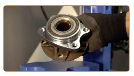
Remplacement : roulement de roue – AUDI A6 Avant (4F5, C6). Les experts d'AUTODOC recommandent :
