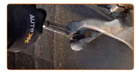
Dévissez l'écrou d'attache d'extrémité à la fusée d'essieu. Utilisez une douille n° 13. Utilisez une clé à cliquet.
