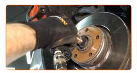
Appliquez du produit sur la fixation reliant l'embout de biellette de direction à la fusée d'essieu. Traitez toutes les articulations du bras. Utilisez de la graisse au cuivre.
