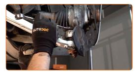
Serrez l'attache du joint rotule. Utilisez une clé mixte de No.21 Utilisez une clé dynamométrique. Serrez-le jusqu'à 110 Nm.
