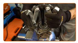
Tirez la bague de roulement intérieure du moyeu de roue. Servez-vous d'un extracteur de roulement. Servez-vous d'un extracteur d'engrenage à 3 bras.
