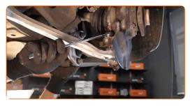
18 Retirez l'écrou de fixation.
