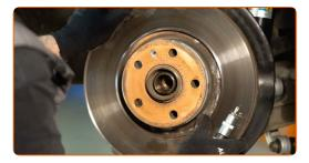
Serrez l'attache du disque de frein. Utilisez la mèche Torx T30. Utilisez une clé dynamométrique. Serrez-le jusqu'à 5 Nm.
