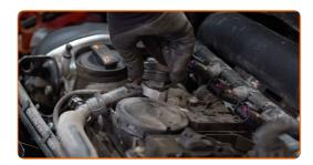
Appliquer du produit sur la bobine d'allumage. Le produit protègera les contacts électriques de la corrosion, de l'oxydation et réduira la résistance des contacts.
