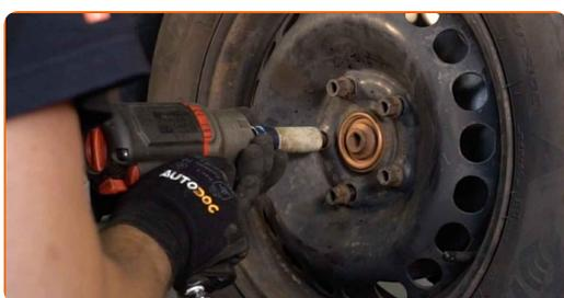
**19** Abaissez la voiture et serrez les boulons de roue en ordre croisé. Utilisez une clé dynamométrique. Serrez-le jusqu'à 120 Nm.
