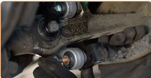
**12** Serrez la fixation reliant la biellette à la barre stabilisatrice. Utilisez une clé mixte de No.16 Utilisez une douille n° 16. Utilisez une clé dynamométrique. Serrez-le jusqu'à 40 Nm.+90°
