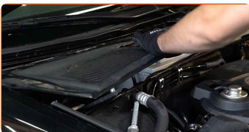
**5** Déverrouillez les clips du couvercle du filtre d'habitacle. Retirez le couvercle du compartiment du filtre habitacle.
