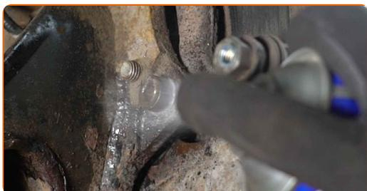
**11** Dévissez l'attache du support d'étrier. Utilisez la clé HEX n° H8. Utilisez un porte-taraud. Utilisez une clé à cliquet.
