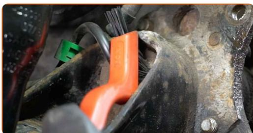
**15** Détachez la fixation du capteur ABS. Utilisez un tournevis plat.
