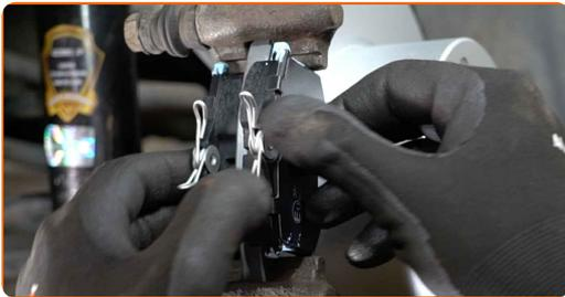
**34** Installez l'étrier de frein et fixez-le. Utilisez une clé mixte de No.15 Utilisez une douille n° 13. Utilisez une clé dynamométrique. Serrez-le jusqu'à 35 Nm.
