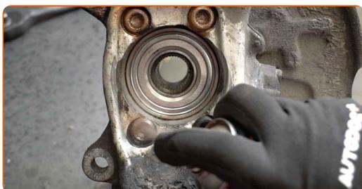
**52** Relâchez l'étau et enlevez le moyeu de roue avec le roulement.
