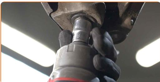
**17** Dévissez l'attache entre le joint rotule et la fusée d'essieu. Utilisez une clé mixte de No.18
