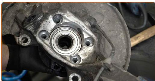
**50** Serrez le moyeu. Servez vous de la douille XZN n°12. Utilisez une clé dynamométrique. Serrez-le jusqu'à 80 Nm.+90°
