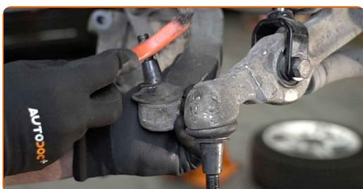
**54** Installez la fusée d'essieu et moyeu dans l'assemblage.
