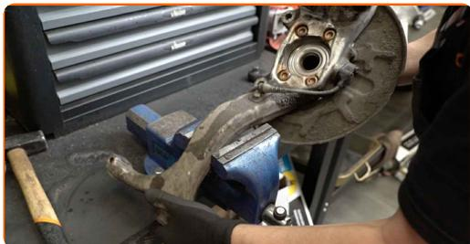
**53** Appliquer un produit sur l'emplacement de montage du moyeu de roue. Utilisez une brosse métallique. Servez vous de l'aérosol WD-40.
