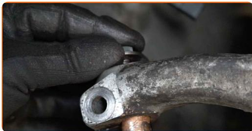
**63** Vissez le boulon de fixation de l'extrémité de la biellette de direction. Utilisez une clé mixte de No.13
