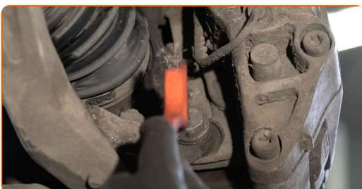
**11** Dévissez l'attache du support d'étrier. Utilisez une douille n° 21. Utilisez une clé à cliquet. Utilisez un porte-taraud.
