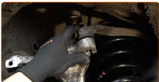
**59** Installez l'écrou de fixation.
