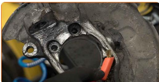
**48** Appliquez du produit sur les boulons de serrage. Utilisez un enduit.
