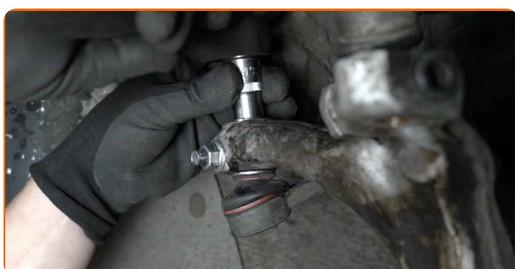
**32** Dévissez l'écrou d'attache d'extrémité à la fusée d'essieu. Utilisez une douille n° 15. Utilisez une clé à cliquet.
