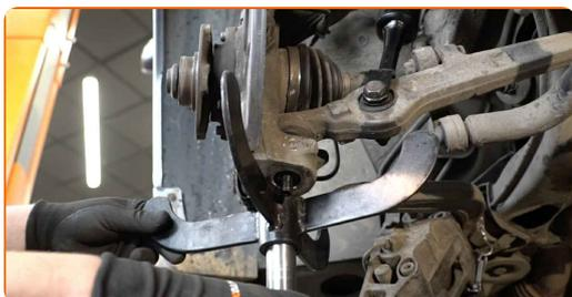
**35** Déconnectez l'extrémité de la barre de la fusée d'essieu. Servez-vous d'un burin plat pour l'usinage des métaux. Servez-vous d'un marteau.
