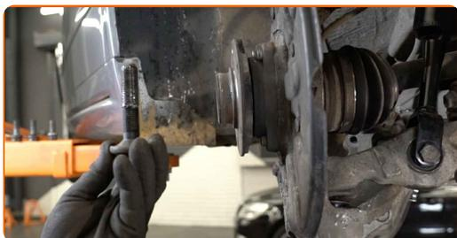
**23** Nettoyez la fixation du capteur ABS. Utilisez une brosse de nettoyage en nylon. Servez-vous d'un aérosol nettoyant multi-usages.
