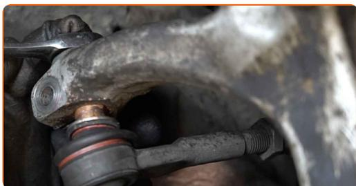
**64** Vissez l'écrou de fixation reliant l'embout de biellette à la fusée d'essieu. Utilisez une douille n° 15. Utilisez une clé à cliquet.
