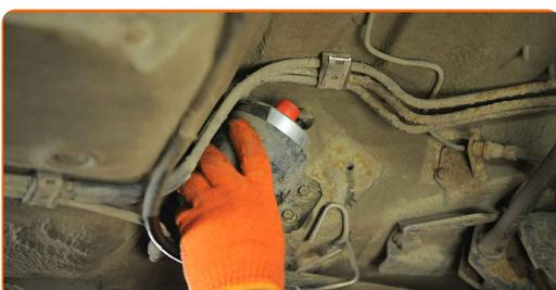
**13** Vissez le boulons de fixation du support du filtre à carburant. Utilisez une douille n° 10. Utilisez une clé à cliquet.
