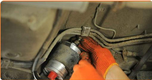
**15** Vissez la fixation reliant la conduite d'alimentation en carburant au carter du filtre à carburant. Utilisez une clé mixte de No.17 Utilisez une clé mixte de No.22
