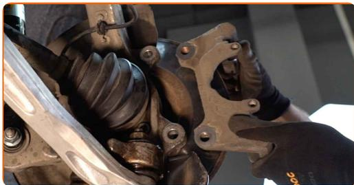
**16** Dévissez l'attache du disque de frein. Utilisez la mèche Torx T30. Utilisez une clé à cliquet.
