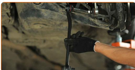
**Remplacement : bras de commande inférieur de suspension arrière – AUDI Allroad (4BH, C5). Conseil :**
