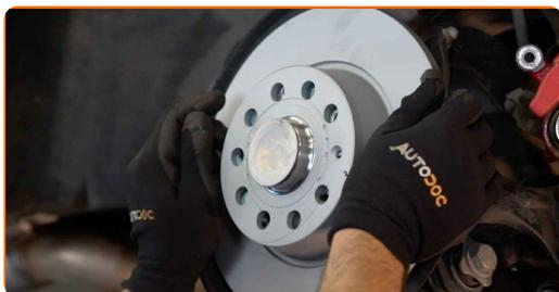
**24** Serrez l'attache du disque de frein. Utilisez la mèche Torx T30. Utilisez une clé dynamométrique. Serrez-le jusqu'à 4 Nm.
