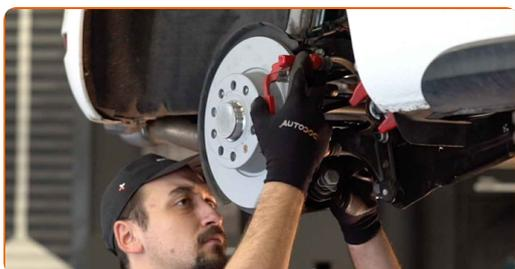
**26** Serrez le support de l'étrier de frein. Servez vous de la douille XZN n°12. Utilisez une clé dynamométrique. Serrez-le jusqu'à 90 Nm.
