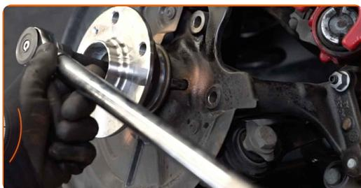
**Remplacement : roulement de roue – AUDI Q3 (F3B). Conseil d'AUTODOC :**
