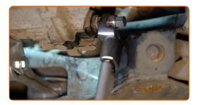
Insérez l'entonnoir. Versez l'huile dans la boite de vitesses par l'orifice de remplissage. Quantité requise d'huile : 1.5 l.
