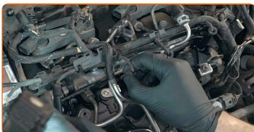
**18** Appliquez du produit sur les connecteurs du faisceau de câbles du moteur. Utilisez de la graisse diélectrique.
