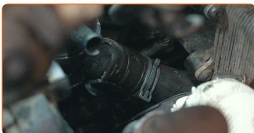
**45** Attachez le collier de serrage au tuyau de refroidissement supérieur. Utilisez des pinces à bec long.
