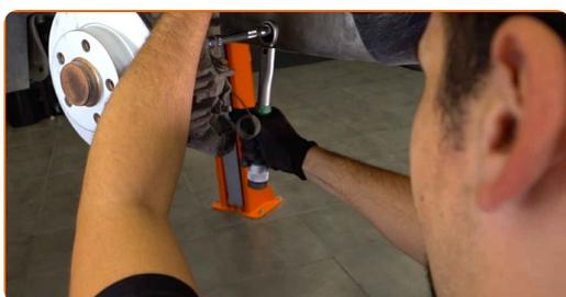
**22** Connectez le capteur électrique d'ABS. Connectez le connecteur du capteur d'usure de la plaquette de frein.
