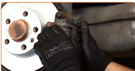
**21** Serrez les fixations de l'étrier de frein. Utilisez une clé mixte de No.15. Utilisez une douille n° 13. Utilisez une clé dynamométrique. Serrez-le jusqu'à 35 Nm.
