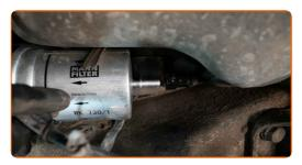
Serrez les attaches du filtre à carburant. Utilisez une douille n° 10.
