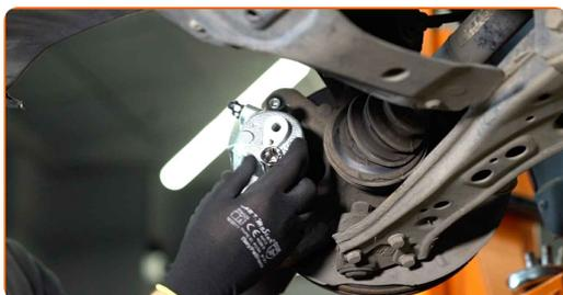
**26** Installez les bouchons anti-poussière des goupilles de guidage de l'étrier de frein.
