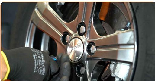
**33** Abaissez la voiture et serrez les boulons de roue en ordre croisé. Utilisez une clé dynamométrique. Serrez-le jusqu'à 120 Nm.
