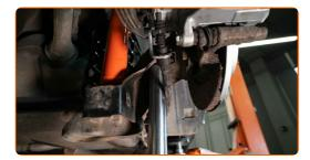
Serrez l'attache inférieure de l'amortisseur. Attention ! Assurez-vous d'utiliser des fixations neuves. Utilisez une clé mixte de No.16. Utilisez une douille n° 16. Utilisez une clé dynamométrique. Serrez-le jusqu'à 40 Nm.+90°
