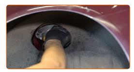
Serrez l'attache de l'amortisseur supérieur. Attention ! Assurez-vous d'utiliser des fixations neuves. Utilisez une douille n° 16. Utilisez une clé dynamométrique. Serrez-le jusqu'à 30 Nm.+90°
