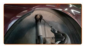
Dévissez l'attache inférieure de l'amortisseur. Utilisez une clé mixte de No.16. Utilisez une douille n° 16.
