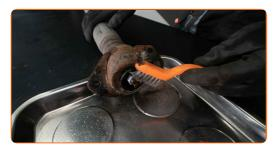
Retirez l'attache de la tige du piston de l'amortisseur. Utilisez une clé mixte de No.16. Servez-vous d'une clé ajustable.
