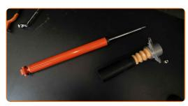
Installez le support supérieur sur le nouvel amortisseur, et sécurisez-le. Utilisez une clé mixte de No.16. Servez-vous d'une clé ajustable. Utilisez une clé dynamométrique. Serrez-le jusqu'à 25 Nm.
