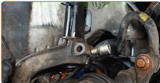
**56** Installez l'écrou de fixation.
