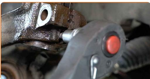
**33** Détachez la fusée d'essieu de la jambe de suspension.
