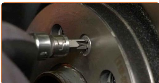
**15** Retirez l'écrou de fixation.
