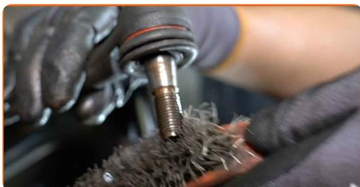
**54** Installez la fusée d'essieu montée avec le moyeu de roue.
