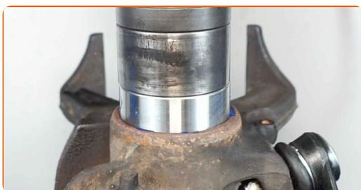
Remplacement : roulement de roue – AUDI TT Roadster (8N9). Les experts d'AUTODOC recommandent :
