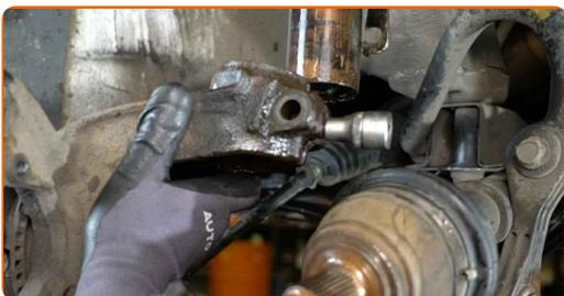
**34** Retirez la fusée d'essieu avec le moyeu de roue.
