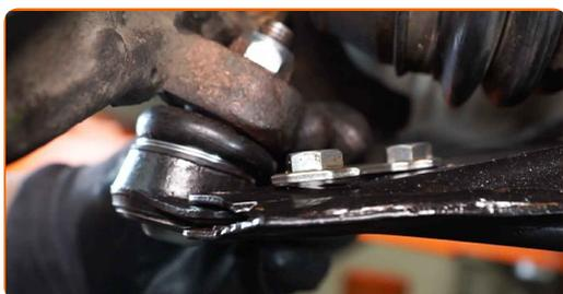
**59** Installez les boulons de fixation.
