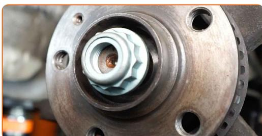
**66** Vissez la fixation du demi-arbre de transmission. Utilisez une douille n° 30. Utilisez une clé à cliquet.
