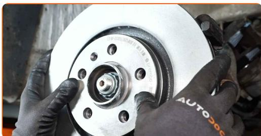
**74** Installez l'écrou de fixation.
