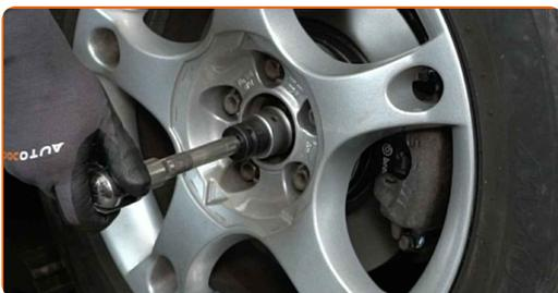
**5** Desserrez les boulons de la roue. Servez-vous d'une douille à choc pour roue N°17. Utilisez un porte-taraud.
