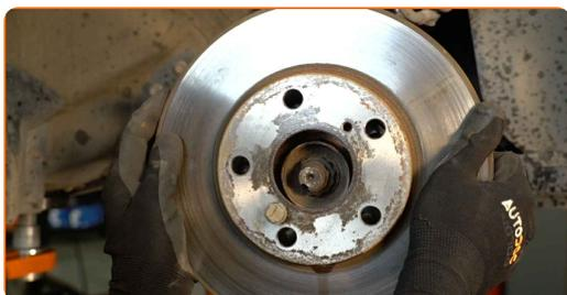
**17** Nettoyez le moyeu. Utilisez une brosse métallique. Traitez la surface de contact. Utilisez de la graisse au cuivre.
