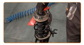
Serrez l'écrou de l'entretoise d'amortisseur due la tige de piston. Utilisez une clé à chaine. Utilisez une douille n° 21. Utilisez une clé dynamométrique. Serrez-le jusqu'à 47 Nm.
