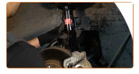
Installez les boulons de fixation.
