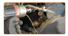
Serrez les fixations inférieures qui relient l'amortisseur à la fusée d'essieu. Utilisez une douille n° 22. Utilisez une clé dynamométrique. Serrez-le jusqu'à 240 Nm.
