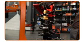
Installez la coupelle, le manchon et la butée de suspension sur l'amortisseur.
