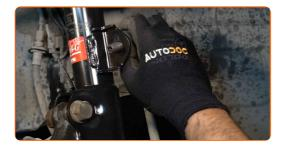
Serrez la fixation reliant la biellette à l'amortisseur. Utilisez une douille n° 17. Utilisez une clé dynamométrique. Serrez-le jusqu'à 74 Nm.
