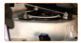
Devissez la fixation supérieure du support d'amortisseur. Utilisez une clé mixte de No.14
