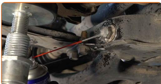
**18** Dévissez l'attache du bras avant. Utilisez une douille n° 22. Utilisez un porte-taraud.
