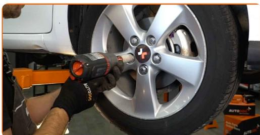
**45** Abaissez la voiture et serrez les boulons de roue en ordre croisé. Utilisez une clé dynamométrique. Serrez-le jusqu'à 103 Nm.
