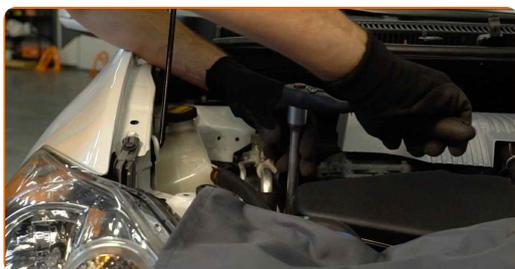
**14** Dévissez la fixation supérieure du support moteur. Utilisez une douille n° 17. Utilisez une clé à cliquet.
