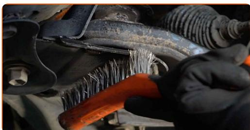
**20** Nettoyez les fixations reliant le bras de commande au sous-châssis. Utilisez une brosse métallique. Servez vous de l'aérosol WD-40.
