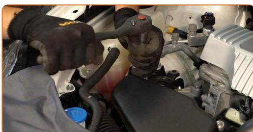
47 Vissez les fixations du réservoir de liquide de refroidissement. Utilisez une douille n° 14. Utilisez une clé à cliquet.
