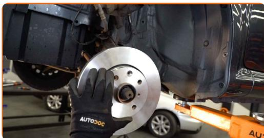
**19** Serrez l'attache du disque de frein. Servez-vous d'un tournevis Phillips. Utilisez une clé dynamométrique. Serrez-le jusqu'à 5 Nm.
