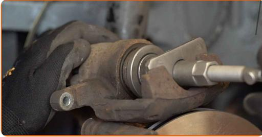
**26** Installez l'étrier de frein et fixez-le. Utilisez une douille n° 13. Utilisez une clé dynamométrique. Serrez-le jusqu'à 30 Nm.
