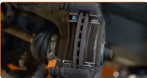
**13** Dévissez l'attache du support d'étrier. Utilisez une douille n° 17. Utilisez un porte-taraud. Utilisez une clé à cliquet.
