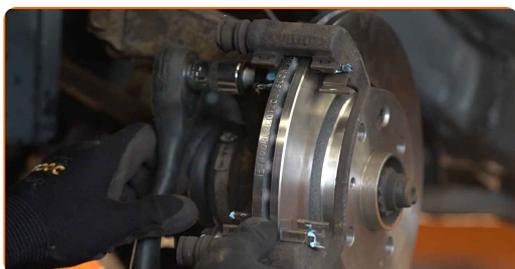
**21** Serrez le support de l'étrier de frein. Utilisez une douille n° 17. Utilisez une clé dynamométrique. Serrez-le jusqu'à 88 Nm.
