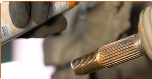
**52** Montez l'arbre de transmission sur le moyeu de roue.
