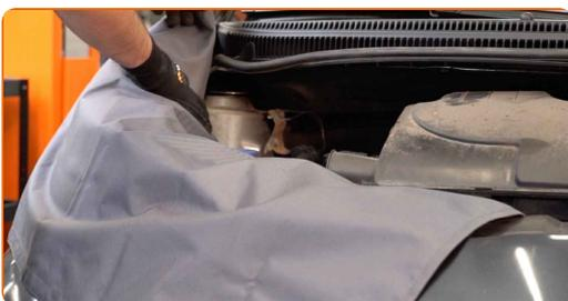
**3** Devissez la fixation supérieure du support d'amortisseur. Utilisez une clé mixte de No.17 Utilisez la clé HEX n° H7.
