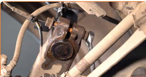
**56** Vissez la fixation qui relie la jambe d'amortisseur à la fusée d'essieu. Utilisez une douille n° 17. Utilisez une clé mixte de No.17.
