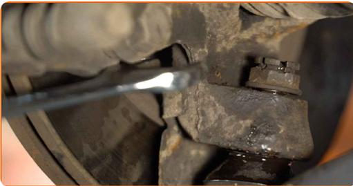
**55** Installez l'écrou de fixation.
