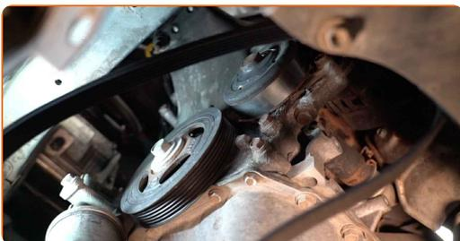
Remplacement : courroie poly V – Toyota Aygo AB1. Les experts d'AUTODOC recommandent :
