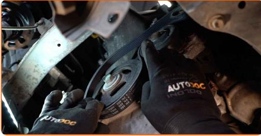
Remplacement : courroie poly V – Toyota Aygo AB1. Les professionnels recommandent :
