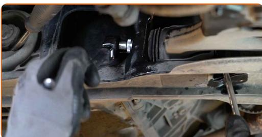
**12** Dévissez l'attache entre le joint rotule et la fusée d'essieu. Utilisez une clé mixte de No.21
