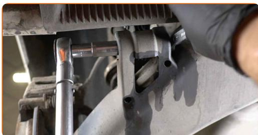
**32** Installez l'écrou de fixation.
