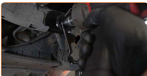
**15** Retirez l'écrou de fixation.
