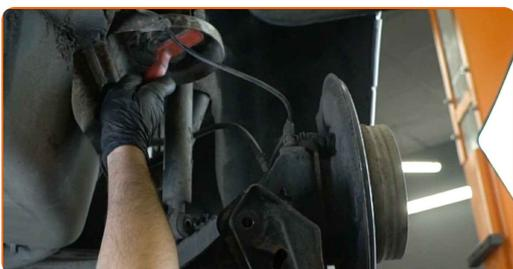
**22** Installez un nouveau ressort hélicoïdal avec ses supports en caoutchouc sur les emplacements de montage.
