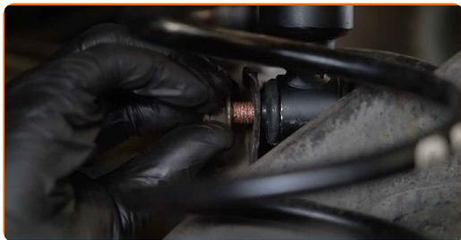
**33** Serrez l'attache inférieure de l'amortisseur. Utilisez une douille n° 16. Utilisez une clé dynamométrique. Serrez-le jusqu'à 70 Nm.
