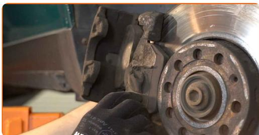
Remplacement : plaquettes de frein – VW Passat B5 Variant. AUTODOC recommande :
