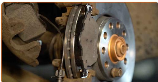
Remplacement : plaquettes de frein – VW Passat B5 Variant. Les professionnels recommandent :
