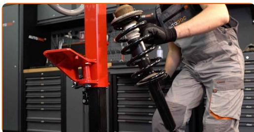
**46** Lubrifiez la barre d'amortisseur. Utilisez de la graisse au cuivre.
