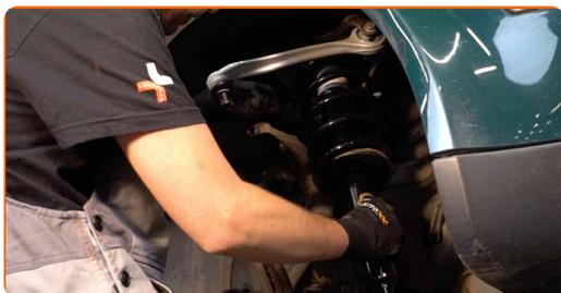
**50** Vissez l'attache supérieure du support de l'amortisseur. Utilisez une douille n° 15. Utilisez une clé à cliquet. Ne serrez pas trop.
