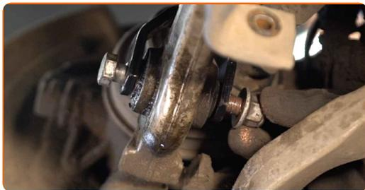
**54** Vissez la fixation inférieure de la jambe d'amortisseur. Utilisez une clé mixte de No.18 Utilisez une douille n° 18.
