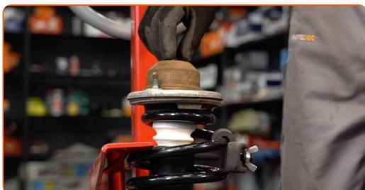
43 Serrez l'écrou de l'entretoise d'amortisseur due la tige de piston. Utilisez la clé HEX n° H6. Utilisez une douille n° 18. Utilisez une clé dynamométrique. Serrez-le jusqu'à 50 Nm.
