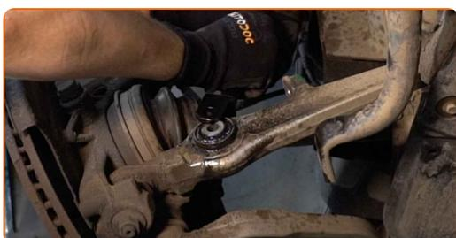
**53** Installez l'écrou de fixation.
