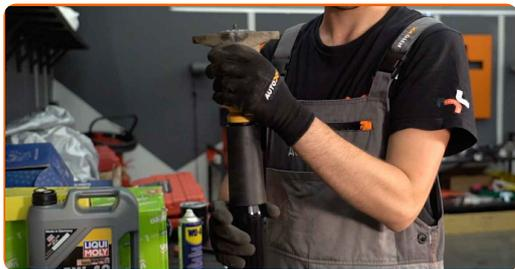
**19** Vissez l'attache supérieure de la tige de piston de l'amortisseur. Utilisez une clé mixte de No.17 Servez-vous de pince-étau. Utilisez une clé dynamométrique. Serrez-le jusqu'à 25 Nm.
