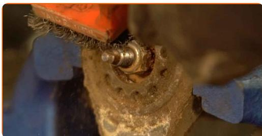
**16** Retirez l'attache de la tige du piston de l'amortisseur. Servez-vous d'un embout d'amortisseur n° 5. Utilisez une douille n° 17. Utilisez une clé à cliquet.
