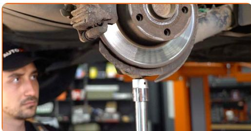
**19** Serrez l'attache inférieure de l'amortisseur. Utilisez une clé mixte de No.16 Utilisez une douille n° 16. Utilisez une clé dynamométrique. Serrez-le jusqu'à 50 Nm.+90°
