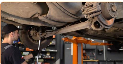
**12** Dévissez l'attache inférieure de l'amortisseur. Utilisez une clé mixte de No.16 Utilisez une douille n° 16. Utilisez une clé à cliquet.
