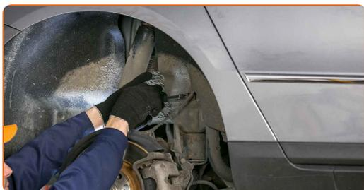
**29** Installez l'écrou de fixation. Attachez la partie inférieure de l'amortisseur.
