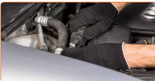
**15** Installez le tuyau d'admission d'air et sécurisez-le. Utilisez un tournevis plat.
