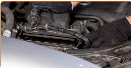
**13** Vissez les trois vis de fixation du couvercle de filtre à air. Servez-vous d'un tournevis Phillips.
