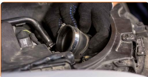
**16** Installez le boîtier du conduit d'air.
