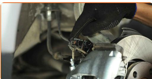
**28** Détachez le vis de purgeur de frein. Utilisez une clé polygonale ouverte #10.
