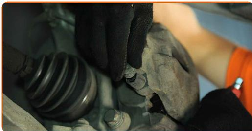
**9** Déconnectez le connecteur du capteur d'usure de plaquette de frein. Utilisez un tournevis plat.
