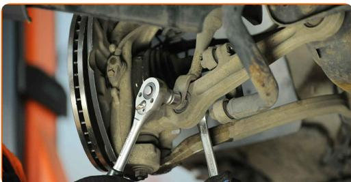
**11.1** Retirez l'écrou de fixation.
