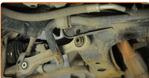
**11.2** Nettoyez les fixations reliant le bras de commande au sous-châssis. Utilisez une brosse métallique. Servez vous de l'aérosol WD-40.
