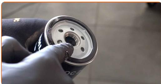
**8** Vissez le filtre neuf en place. Utilisez la douille 67-14F. Utilisez une clé dynamométrique. Serrez-le jusqu'à 25 Nm.
