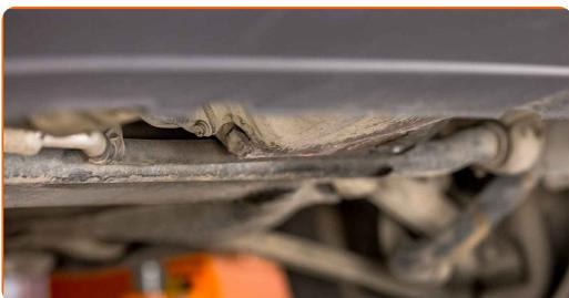
**10** Dévissez le bouchon de vidange. Utilisez une douille n° 19. Utilisez une clé à cliquet.
