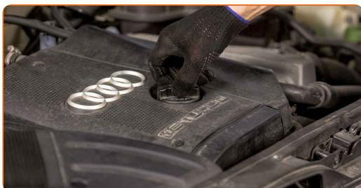
**18** Retirez le bouchon du bec de remplissage d'huile.
