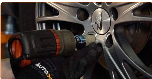
Remplacement : disques de frein – Audi A4 B6 Avant. AUTODOC recommande :
