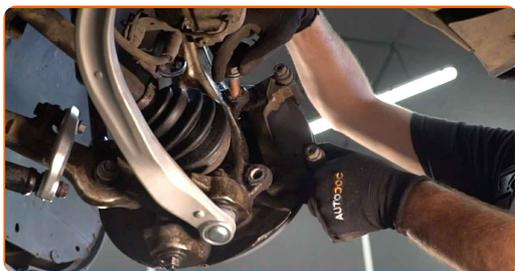
**23** Serrez le support de l'étrier de frein. Utilisez une douille n° 21. Utilisez une clé dynamométrique. Serrez-le jusqu'à 190 Nm.
