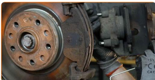
Remplacement : plaquettes de frein – VW Passat Variant B6. Les professionnels recommandent :
