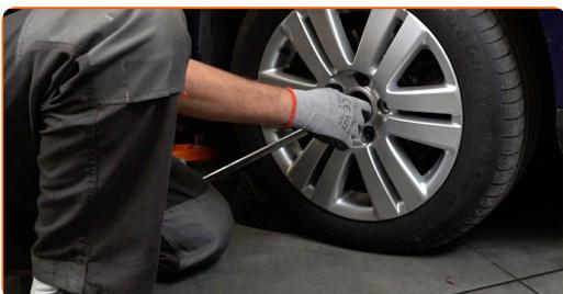
**10** Desserrez les boulons de fixation de la roue. Servez-vous d'une douille à choc pour roue N°17.
