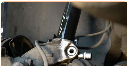
**54** Installez l'écrou de fixation.
