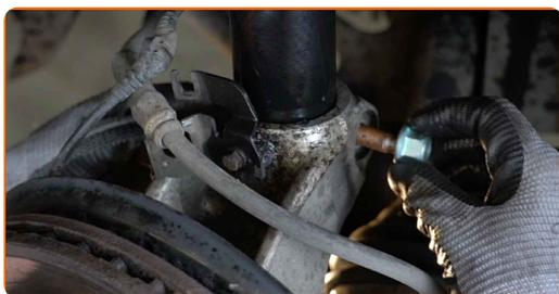
**55** Vissez la fixation qui relie la jambe d'amortisseur à la fusée d'essieu. Utilisez une douille n° 18. Servez vous de la douille XZN n°14. Utilisez une clé à cliquet.
