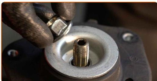
**46** Serrez l'écrou de l'entretoise d'amortisseur due la tige de piston. Utilisez une douille n° 19. Utilisez la clé HEX n° H6. Utilisez une clé dynamométrique. Serrez-le jusqu'à 60 Nm.
