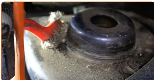
**7** Devissez la fixation supérieure du support d'amortisseur. Utilisez une douille n° 13. Utilisez une clé à cliquet.
