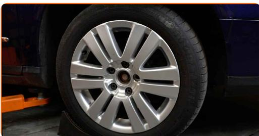
**9** Desserrez le boulon du moyeu de roue. Servez-vous d'une douille 12 pans N°24. Utilisez un porte-taraud.
