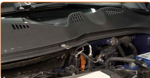
**76** Installez les fixations sur le cache d'auvent.
