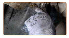
Dévissez les fixations qui lient le joint à rotule au bras de contrôle de suspension. Utilisez une douille n° 16. Utilisez un porte-taraud.
