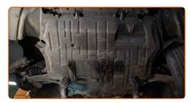
Serrez les fixations du carénage sous moteur. Utilisez une douille n° 13. Utilisez la mèche Torx T25. Utilisez une clé à cliquet.
