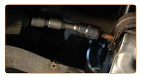
Installez la fixation arrière du bras de commande (2 pièces).
