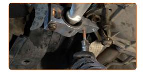
Resserrez les fixations de la rotule. Utilisez une douille n° 16. Utilisez une clé dynamométrique. Serrez-le jusqu'à 60 Nm.
