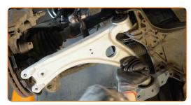
Vissez l'attache du bras avant. Utilisez une douille n° 18. Utilisez une clé à cliquet.
