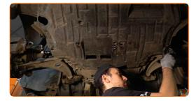
7 Retirez le carénage sous moteur.
