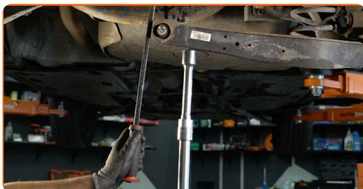
Remplacement : bras de commande inférieur de suspension arrière – VW
