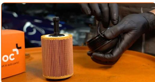
**24** Installez les nouveaux filtres à huile sur les sièges de montage sur le couvercle du filtre.
