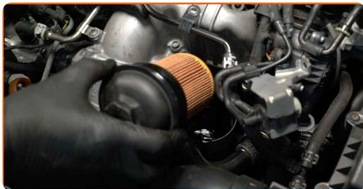
**27** Installez un nouveau couvercle de compartiment à filtre à huile, et serrez. Utilisez une douille n° 32. Utilisez une clé dynamométrique. Serrez-le jusqu'à 25 Nm.
