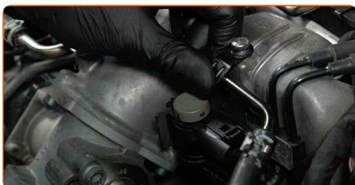
**29** Vissez le support du circuit de dépression. Utilisez la mèche Torx T20. Utilisez une clé à cliquet.
