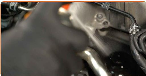
**12** Dévissez le bouchon du compartiment du filtre, ainsi que l'ancien élément filtrant. Utilisez une douille n° 32. Utilisez une clé à cliquet.
