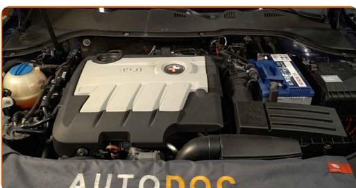
**38** Vérifiez le niveau d'huile cinq minutes après l'arrêt du moteur à l'aide d'une jauge, et ajoutez de l'huile si nécessaire.
