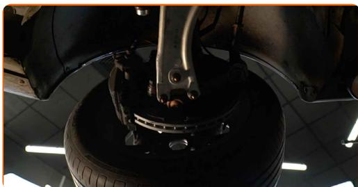
Remplacement : rotule de direction – Passat 3C5. Les experts d'AUTODOC recommandent :
