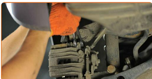
**39** Appliquez du produit sur la zone de contact entre le disque de frein et la jante. Utilisez de la graisse au cuivre.
