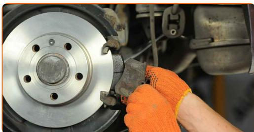
**35** Appliquez du produit sur les boulons de serrage. Utilisez un enduit.
