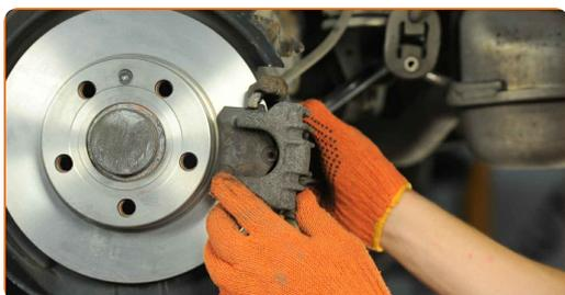
**37** Installez les boulons de fixation (2 pièces).
