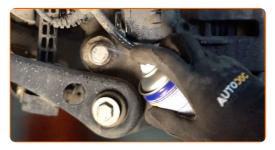
Dévissez l'attache inférieure de l'amortisseur. Utilisez une clé mixte de No.21. Utilisez une douille n° 21. Utilisez une clé à cliquet.
