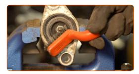
Retirez l'attache de la tige du piston de l'amortisseur. Utilisez une clé mixte de No.17. Servez-vous d'une clé ajustable.
