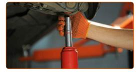
Retirez l'écrou de fixation.
