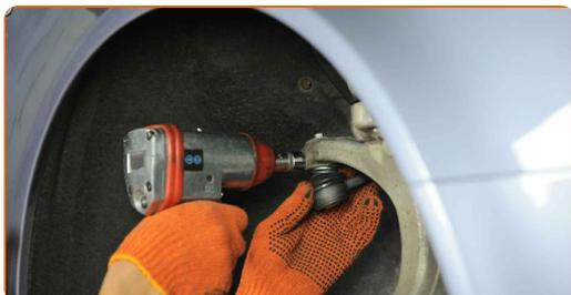
**20** Serrez l'écrou de blocage de l'extrémité de la barre. Utilisez une clé mixte de No.18 Utilisez une clé mixte de No.22 Utilisez une clé dynamométrique. Serrez-le jusqu'à 40 Nm.
