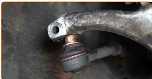
**17** Installez l'écrou de fixation.
