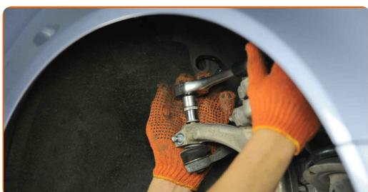
**19** Serrez l'écrou de fixation reliant l'embout de biellette de direction à la fusée d'essieu. Utilisez une douille n° 16. Utilisez une clé dynamométrique. Serrez-le jusqu'à 45 Nm.
