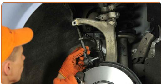
Remplacement : rotule de direction – Audi A4 B7 Avant. Les experts d'AUTODOC recommandent :
