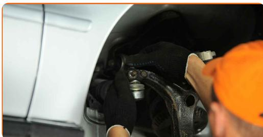
**18** Serrez l'écrou de fixation reliant l'embout de biellette de direction à la fusée d'essieu. Utilisez une douille n° 13. Utilisez une clé dynamométrique. Serrez-le jusqu'à 7 Nm.
