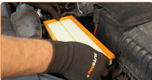
Remplacement : filtre à air – VW Passat B7 berline. AUTODOC recommande :
