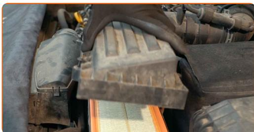
6 Retirez l'élément filtrant du compartiment du filtre.
