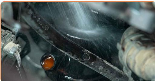
**36** Dévissez les fixations du boîtier du thermostat. Utilisez une douille n° 10. Utilisez une clé à cliquet.
