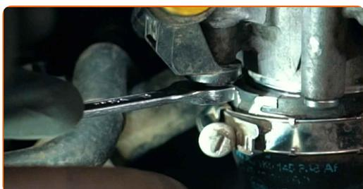
61 Maintenez la fixation du conduit d'admission d'air. Utilisez une douille n° 7. Utilisez une clé à cliquet.
