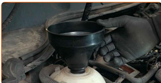
66 Versez du liquide de refroidissement dans le réservoir.
