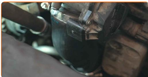
60 Vissez la fixation du tube de la jauge d'huile. Utilisez une clé mixte de No.10
